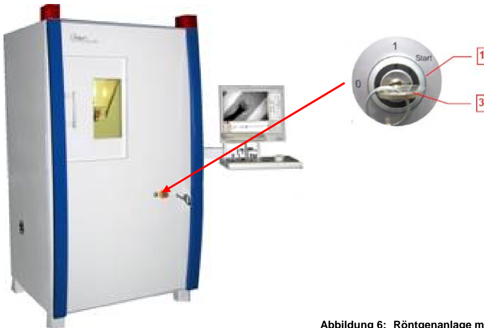
Abbildung 6: Röntgenanlage mit Schalterschlüssel
