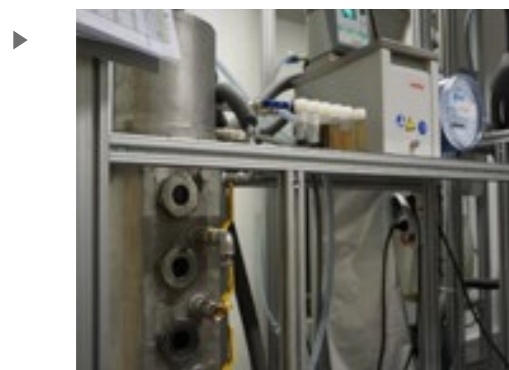
3 x 30 Liter Hochlastfermenter (Festbett- und Pellet-Technologie) zur Vergärung landwirtschaftlicher Substrate (z.B.: Rinder- und Schweinegülle)
