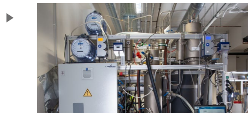
4 x 40 Liter zweistufige Biowasserstoff - und Bio-methananlage zur kontinuierlichen Erzeugung von Wasserstoff aus Abwässern und biogenen Reststoffen bei Verwendung verschiedener Reaktortypen
