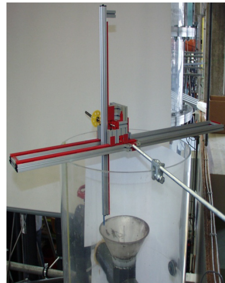
Bild 3: Apparatur zur Überfallhöhenmessung
