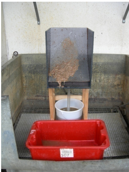
Abb. 1: Bogensieb (Siebfläche 30 · 60 cm; Lochweite 0,5 mm) mit Rückständen aus dem Abwasser der DB Regio.
