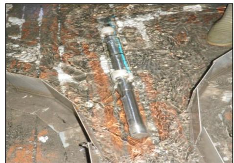
Bild 1: Spektrometersonde in kanalisiertem Bachlauf
