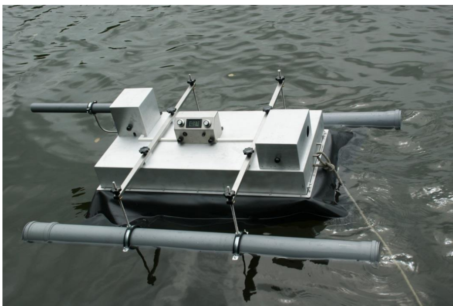
Abbildung 13: Praktischer Nachweis zur Schwimmfähigkeit der neu gestalteten Probenahmehaube
