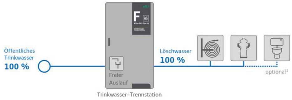
Abbildung: Trinkwasser-Trennstation für Wand- und Außenhydranten
