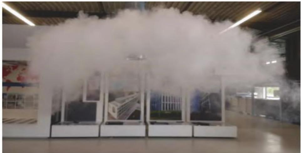
Abbildung: Rauchversuch des 400er IVA's im Kühlbetrieb
