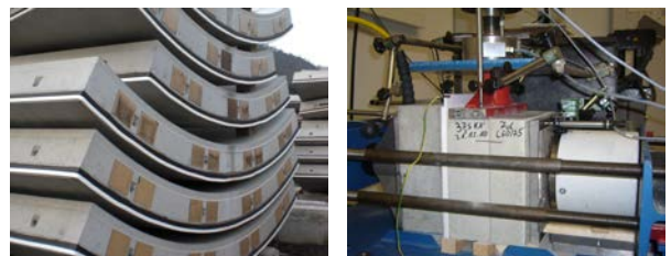
Untersuchungen zur Reibungskopplung von Tübbingelementen
